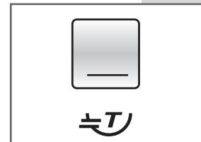
**ПОДЕСИВА БРЗИНА ЦЕНТРИФУГИРАЊА:** Дугме **C** можете притиснути да бисте променили брзину центрифугирања у складу са изабраним програмом прања или врстом тканице. Изабрана брзина центрифугирања ће се појавити на LCD-у. Да бисте онемогућили крај циклуса центрифугирања, изaberite вредност „00“.
