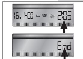
**ЗАДЕРЖКА ПУСКА** Данная функция позволяет отложить начало цикла стирки максимум на 16 часов. Нажмите несколько раз кнопку **B**, пока на дисплее не появится нужное время задержки пуска. На дисплее мигает символ **h** до тех пор, пока не начнется цикл стирки.
