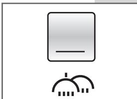
**VOORWAS:** druk op de knop **D** om de voorwas in te schakelen en vul het bakje 1 met wasmiddel. De wasmachine voert een voorwas uit op max. 40°C. De voorwas is aanbevolen bij wasgoed vol stof, grond, zand of bij hardnekkige vlekken. Zie de programmatabel voor meer informatie.
