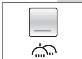
**PŘEDPÍRÁNÍ:** Chcete-li provést předpírání, stiskněte tlačítko **D** a přidejte prací prostředek do příslušné vaničky 1. Pračka provede předpírání maximálně při 40°C. Předpírání je vhodné provádět u oděvů znečištěných prachem, zeminou či pískem nebo v případě zvláště odolných skvrn. Podrobnější informace jsou uvedeny v tabulce programů.
