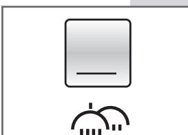
**PRESPĂLARE:** Pentru a efectua Prespălarea apăsați pe butonul D și adăugați detergentul în casoletă corespunzătoare 1. Mașina de spălat rufe va efectua o Prespălare la max 40°C. Prespălarea este indicată în cazul rufelor murdare de praf, pământ, nisip sau în cazul în care petele de pe rufe sunt deosebit de rezistente. A se vedea Tabelul cu Programe pentru alte informații.
