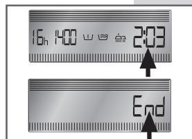
**ARRANQUE DIFERIDO:** Esta função permite adiar o arranque do ciclo de lavagem até um máximo de 16 horas. Prima várias vezes o botão B até aparecer indicado no display o tempo de adiamento do arranque desejado. O ícone **h** piscará no display até ao momento do arranque do ciclo de lavagem.
