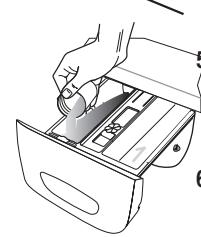
4. Dozați cantitatea adecvată de detergent în casoletă respectivă **2**. Introduceți separatorul din dotare în cazul în care se utilizează detergenți lichizi. Dacă se dorește activarea opțiunii de Prespălare adăugați detergentul în casoletă **1**. Pentru lichidul emolient, întrebuițați casoletă însemnată cu simbolul corespunzător ☈ . După ce ati vărsat detergentul închideți încet sertarul.
