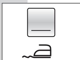
**ФУНКЦИЯ EASY IRON (простая гладжка)** При выборе функции простой гладжки (Easy Iron) кнопкой G стиральная машина регулирует параметры стирки, чтобы снизить степень смятия вещей, упрощая тем самым дальнейшую их гладжку. Скорость отжима автоматически настраивается на 500 об/мин.
