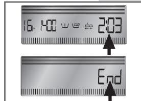
**KÉSLELTETETT INDÍTÁS:** Ezzel a funkcióval maximum 16 órával késleltethető a mosási ciklus elindítása. Addig ismételje a **B** gomb megnyomását, amíg a kijelzőn meg nem jelenik a kívánt késleltetési idő. A ciklus elindulásáig a kijelzőn h ikon villog.
