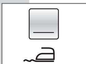
**EASY IRON:** Attivando l'opzione easy iron tramite il pulsante **G**, la lavabiancheria regola i parametri di lavaggio per diminuire la formazione di pieghe facilitando le operazioni di stiratura. La velocità di centrifuga viene impostata automaticamente a 500 giri/min.
