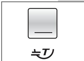
**CENTRÍFUGA REGULABLE:** Presionando el pulsador **C** la velocidad de centrífuga puede regularse en función del programa de lavado seleccionado y del tipo de tejidos. En el display LCD se ilustrará el valor de velocidad seleccionado. Para excluir la centrífuga al final del ciclo seleccionar el valor "00".
