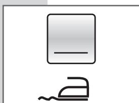
**EASY IRON:** Po uruchomieniu opcji Łatwe Prasowanie (Easy Iron) przyciskiem **G**, pralka automatycznie wyreguluje parametry prania w celu zminimalizowania zagnieć tkaniny, ułatwiając jednocześnie jej prasowanie. Prędkość wirówki zostaje automatycznie ustalona na 500 obrotów na minutę.
