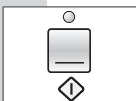
**ПУСК:** Під час вибору програм та опцій прання СВІТЛОДІОД пуску залишається вимкненим. Для підтвердження вибору та запуску циклу прання натисніть кнопку **H**. При цьому індикатор загориться.
