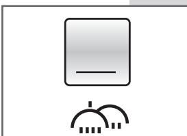
**PRELAVAGGIO:** Per effettuare il prelavaggio premere il pulsante **D** ed aggiungere il detersivo nell'apposita vaschetta **1**. La lavabiancheria effettua un prelavaggio a 40°C max. Il prelavaggio è indicato nel caso di indumenti sporchi di polvere, terra, sabbia o in presenza di macchie particolarmente resistenti. Vedere la tabella programmi per ulteriori informazioni.
