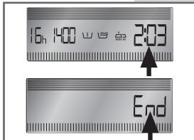
**PORNIRE CU ÎNTÂRZIERE** Această funcție permite amânarea pornirii ciclului de spălare până la maxim 16 ore. Apăsați butonul B de repetate ori până când pe ecran nu va fi afișată perioada de întârziere dorită. Icoana h va licări pe afișaj până la pornirea ciclului de spălare.
