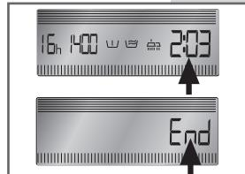
**STARTVERZÖGERUNG:** Mit dieser Taste kann der Start des Waschgangs um bis maximal 16 Stunden verzögert werden. Die Taste B mehrmals drücken, bis am Display die gewünschte Verzögerungszeit sichtbar wird. Das Symbol h blinkt am Display, bis der Waschgang angelaufen ist.
