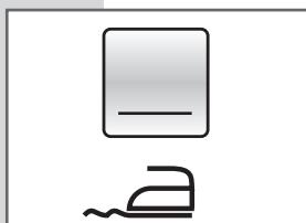
**EASY IRON:** als de optie Easy Iron met de knop **G** wordt ingeschakeld, dan stelt de wasmachine de werkingsparameters in om kreukvorming te verminderen en het strijken te vergemakkelijken. De centrifugesnelheid wordt automatisch ingesteld op 500 toeren/min.
