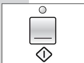
**START:** Durante la fase de selección de los programas y de las opciones de lavado el LED start se queda apagado. Para confirmar las selecciones y poner en marcha el ciclo de lavado presionar el pulsador **H**. El LED se enciende.
