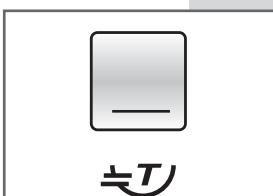
**CENTRIFUGA REGLABILĂ:** Apăsând pe butonul C viteza de centrifugare poate fi reglată în funcție de programul de spălare ales și de tipul de materiale. Pe afișajul LCD va fi indicată valoarea vitezei selectate. Pentru excluderea centrifugării la terminarea ciclului selectați valoarea "00".
