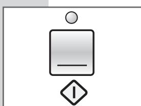
**START:** În timpul fazei de selecție a programelor i opțiunilor de spălare LED-ul start rămâne stins. Pentru a confirma alegerile și pentru pornirea ciclului de spălare apăsați pe butonul H. LED-ul se va aprinde.
