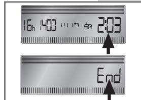
**DÉPART DIFFÉRÉ :** cette fonction permet de différer le démarrage du cycle de lavage jusqu'à 16 heures maximum. Appuyer plusieurs fois sur la touche **B** jusqu'à ce qu'apparaîsse sur l'afficheur le délai voulu avant le départ. L'icône **h** clignotera sur l'afficheur jusqu'au démarrage du cycle de lavage.
