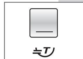
**REGULOVATEĽNÁ RÝCHLOSŤ ODSTREDOVANIA:** Stláčaním tlačidla C sa rýchlosť odstredovania dá regulovať v závislosti od zvoleného programu prania a od druhu tkanín. Na displeji LCD sa zobrazí hodnota zvolenej rýchlosťi. Aby ste odstredovanie vylúčili, po ukončení cyklu zvoľte hodnotu "00".
