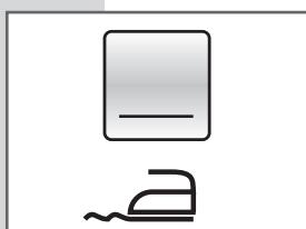
**EASY IRON:** A G gombbal aktiválható Easy Iron funkciónál a készülék úgy állítja be a mosási paramétereket, hogy a könnyebb vasalás érdekében csökkenjen a ráncképződés mértéke. A centrifugálási sebesség automatikusan 500 fordulat/perc értékre állítódik.
