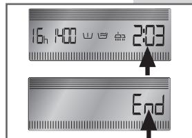
**ODLOŽENÝ START:** Tato funkce umožňuje posunout start pracího cyklu maximálně o 16 hodin. Stiskněte opakovaně tlačítko **B**, dokud se na displeji nezobrazí požadovaný odložený start. Na displeji bude blikat ikona h až do spuštění pracího cyklu.
