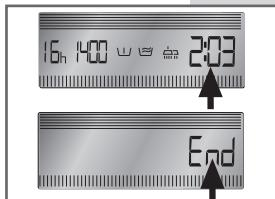
**PARTIDA RETRASADA:** Esta función permite retrasar la partida del ciclo de lavado hasta un máximo de 16 horas. Presionar repetidamente el pulsador **B** hasta que en el display se visualiza el retraso de partida deseado. El icono h parpadea en el display hasta la puesta en marcha del ciclo de lavado.
