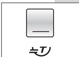
**INSTELBARE CENTRIFUGE:** met de knop **C** kan de centrifugesnelheid worden ingesteld op basis van het gekozen wasprogramma en van het type wasgoed. Op het LCD-display wordt de gekozen snelheidswaarde weergegeven. Om de centrifuge na de wascyclus uit te schakelen kiest u de waarde '00'.
