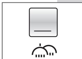
**ПРЕДВАРИТЕЛЬНАЯ СТИРКА** Чтобы выполнить предварительную стирку вещей, нажмите кнопку **D** и добавьте моющее средство в специальное отделение **1**. Стиральная машина выполняет предварительную стирку при температуре макс. 40°C. Предварительную стирку рекомендуется проводить для вещей, испачканных пылью, землей и песком, или при наличии застаревших пятен. Дальнейшую информацию см. в Таблице программ.
