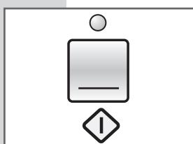
**СТАРТ** При выборе программ и опций стирки, светодиод запуска остаётся выключенным. Чтобы подтвердить сделанный выбор и включить цикл стирки, нажмите кнопку H. Соответствующий световой индикатор загорается.
