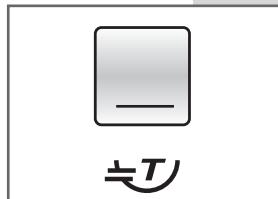
**ESSORAGE RÉGLABLE :** appuyer sur la touche **C** pour régler la vitesse d'essorage en fonction du programme de lavage choisi et du type de tissu. La vitesse sélectionnée apparaît sur l'afficheur ACL. Pour exclure l'essorage à la fin du cycle, sélectionner la valeur « 00 ».
