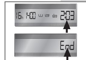
**POSUNUTÝ ŠTART:** Táto funkcia umožňuje posunúť spustenie cyklu prania až o maximálne 16 hodín. Opakovane stláčajte tlačidlo B, kým sa na displeji nezobrazí želaná doba posunutia štartu. Ikona h bude blikáť na displeji, až kým sa nespustí cyklus prania.
