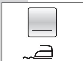
**EASY LOGIC:** Aktiváciou voliteľnej funkcie prostredníctvom tlačidla G práčka upraví parametre prania, aby sa znížilo pokŕcenie bielizne a uľahčilo sa nasledovné žehlenie. Rýchlosť odstredovania sa automaticky nastaví na 500 otáčok/min.
