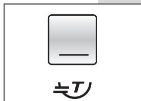
**РЕГУЛИРУЕМАЯ СКОРОСТЬ ОТЖИМА** Нажатием кнопки **C** можно отрегулировать скорость отжима в зависимости от выбранной программы стирки и типа стираемых вещей. На ЖК-дисплей выводится выбранное значение скорости. Чтобы исключить отжим вещей в конце цикла, выберите значение «00».
